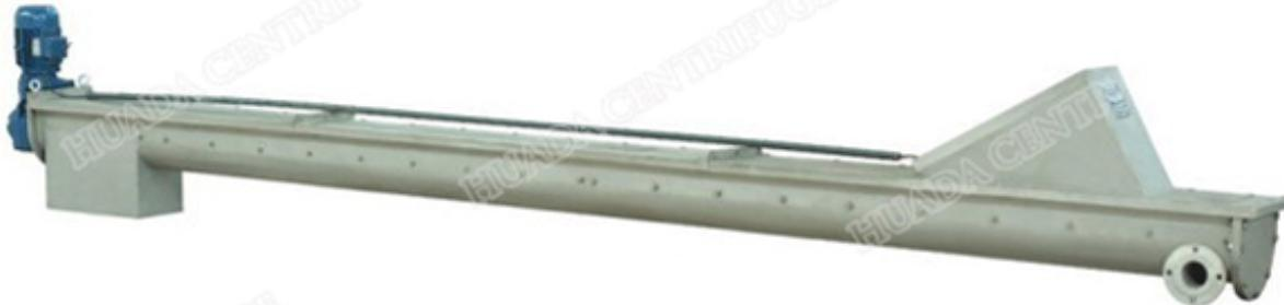
Безваловый шнековый транспортер (LS – низкоскоростной) включает приводное устройство, винтовые лопасти, U-образную сменную износостойкую обшивку и стойку. Устройство применяется для транспортировки обезвоженного осадка из оборудования в отдельное наружное хранилище или транспортные средства. Весь процесс проходит в закрытом состоянии для поддержания чистой окружающей среды.
