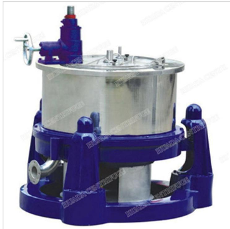
Вертикальная трёхколонная центрифуга со скребками и ручной нижней выгрузкой SG имеет практически одинаковое назначение и области применения, что и вертикальная трёхколонная центрифуга с автоматической нижней разгрузкой серии SGZ. Тем не менее, центрифуги SG значительно отличаются по своим характеристикам.
